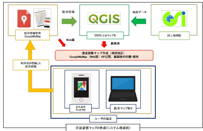
図-3 津波避難マップの作成手法の流れ
